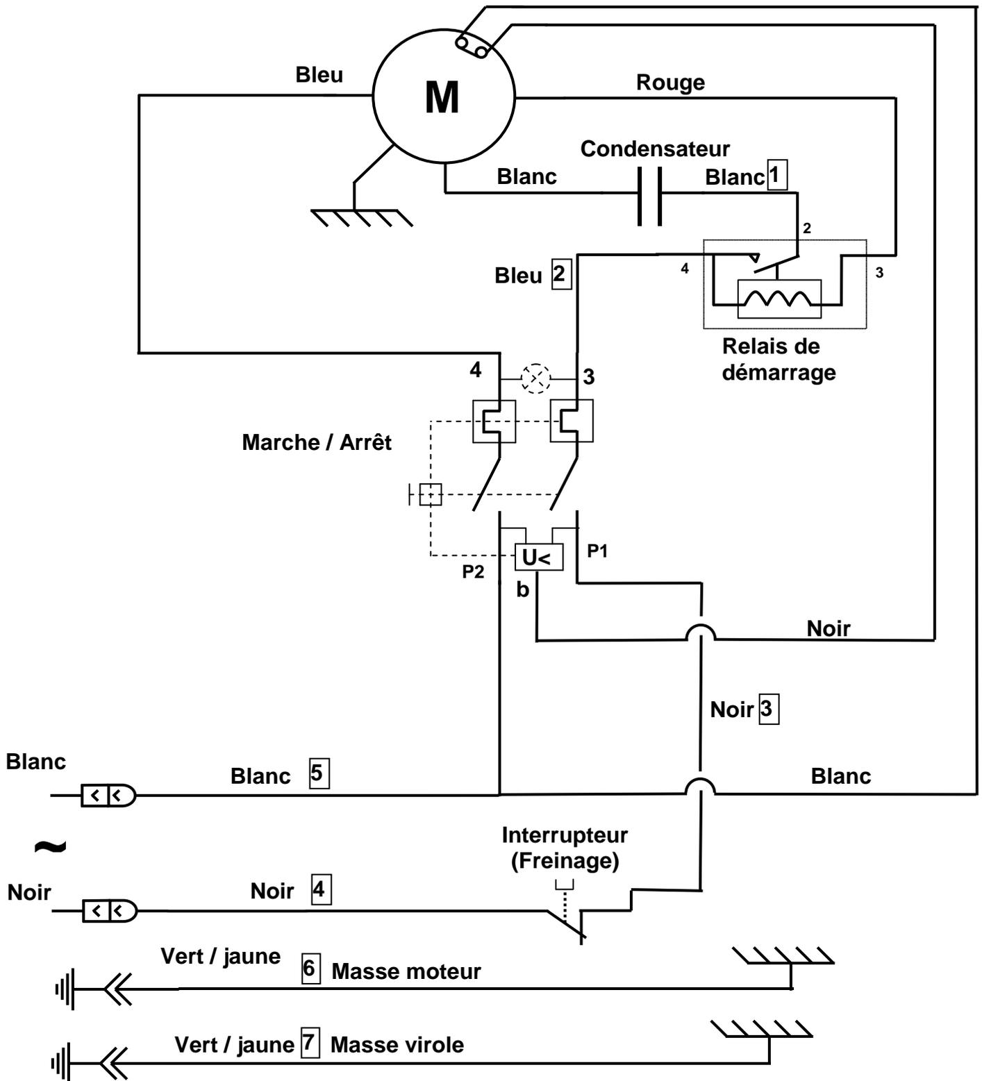
Schéma électrique : 220-240V 50/60Hz
